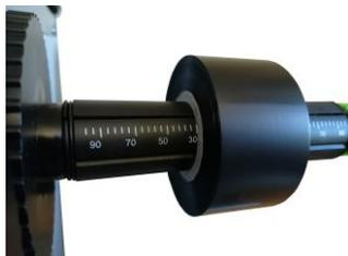
Una volta posizionato, ruotare la ghiera di colore verde, posta all'estremità del mandrino, in senso antiorario, fino a fissare il rotolo.
