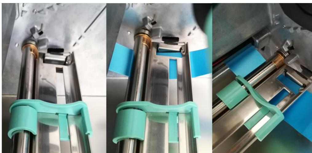
Far passare il nastro attraverso la testina di stampa avendo cura che la freccia bianca del sensore (cerchiata in rosso nella figura sottostante) sia posizionata sopra al nastro da stampare.
